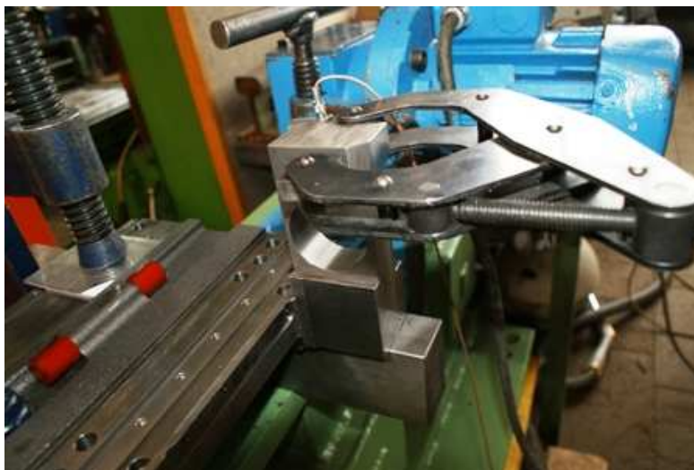
Messsonde am Werkstück, um die Beschleunigung zu registrieren
