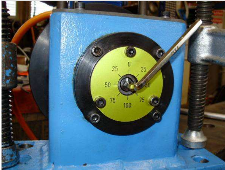
Einstellung der Exzenter-Stufe: Fliehkraft der Erregerenergie bis 12868 N (WIAP LC 20)
